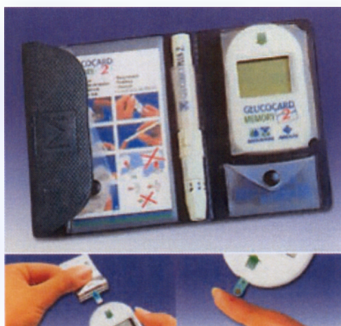
Εικ. 4.3. : Μηχάνημα που ελέγχει το ζάχαρο του αίματος, μπορεί κ μόνος του ο ασθενείς να το χρησιμοποιεί και μάλιστα έχει μνήμη για να αποθηκεύονται οι τιμές του ζαχάρου κάθε μέτρησης και έτσι ο γιατρός να μπορεί να έχει μια ολοκληρωμένη άποψη.
