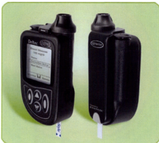
Εικόνα 3.2: Αντλίες Ινσουλίνης με τον μετρητή
