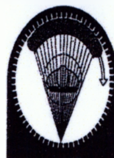
Σχήμα 2.8 : Σχηματική παράσταση Υ. Τ 4 ης γενιάς. Φαίνεται η περιστροφική κίνηση μόνο της λυχνίας σε σχέση με την σταθερή κυκλική διάταξη των ανιχνευτών.
