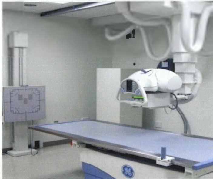
Σχήμα 2.1: Διάταξη σύγχρονου ακτινογραφικού μηχανήματος (universal)
