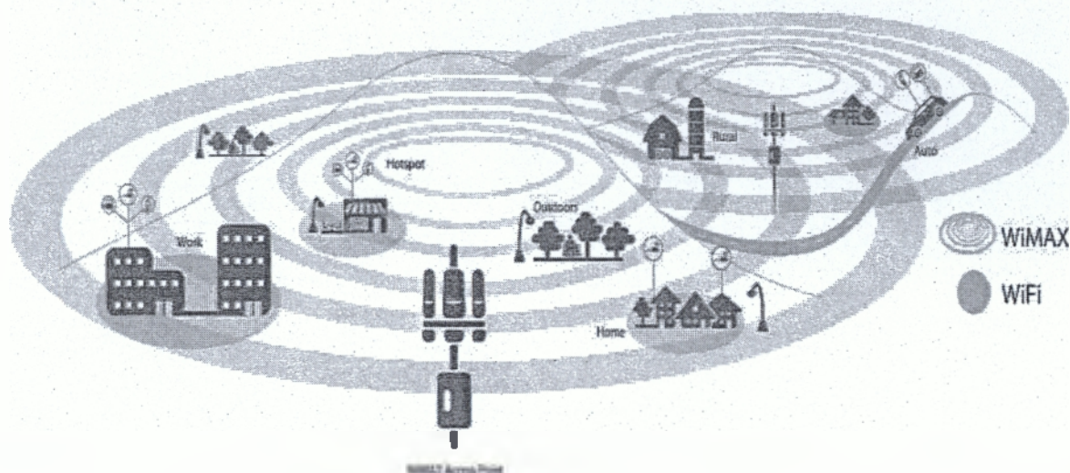
Εικόνα 20: Χρήση WiMAX και WiFi μαζί για πλήρη κάλυψη [50]
