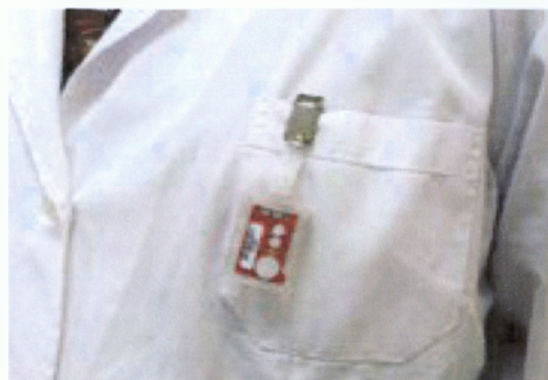
Εικόνα 3.7: Ατομικό δοσίμετρο τύπου TLD.
