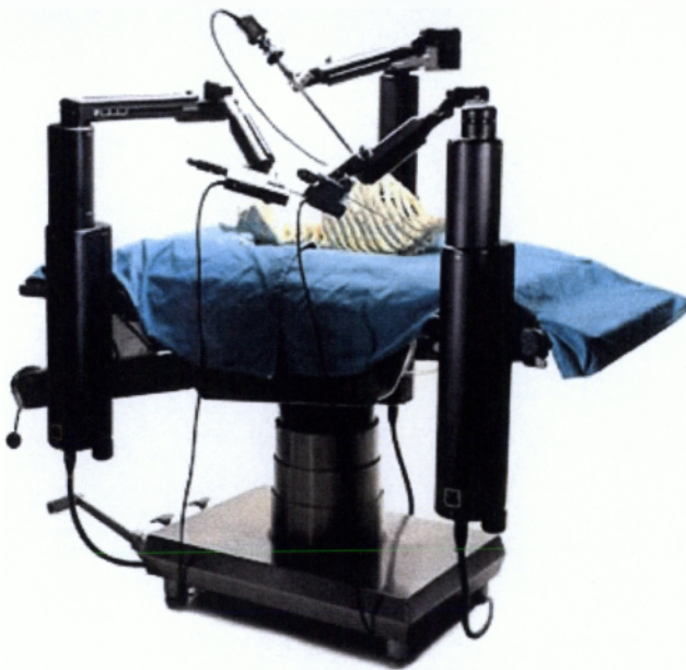
Εικόνα 27 : Στα ρομποτικά συστήματα τύπου master-slave ανήκουν τα χειρουργικά συστήματα Zeus .
