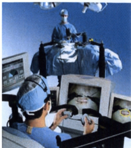
Εικόνα 31: κονσόλα Zeus (Zeus master controller and robotic system in surgical procedure).
