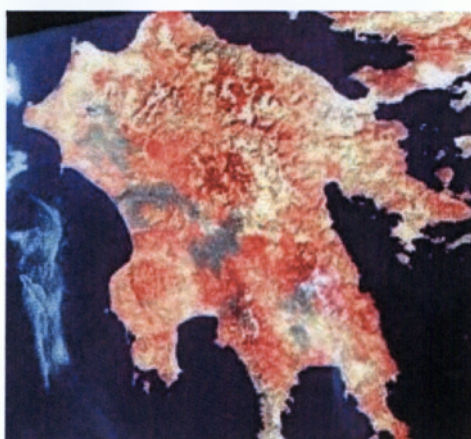
Εικ.2.19 Δορυφορική απεικόνιση της Πελοποννήσου μέσω του συστήματος Modis όπου με γκρι εμφανίζονται οι καμένες περιοχές και με κόκκινο τα δάση
