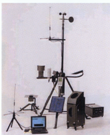
Εικόνα 2.8: Αυτόματος Μετεωρολογικός σταθμός
