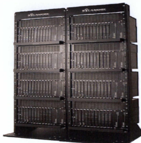
Εικόνα 48 Σύνδεση S-DNX του δικτύου Sycamore
