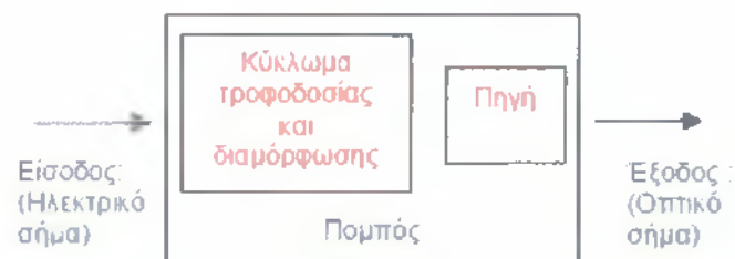
Σχήμα 2.1 Λειτουργία οπτικού πομπού
