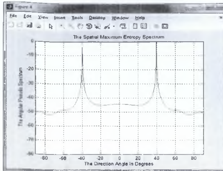
Σχήμα 6.40 Ψευδοφάσμα του Maximum Entropy με : Γωνίες Αφίξης είναι ( -40^{\circ} , 40^{\circ} ), αριθμό των Elements 8 , αριθμό των Users 2 , αριθμό των Samples 10 και το Signal to Noise Ration per samples 20 .
