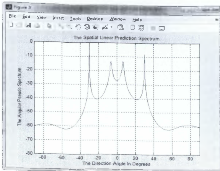
Σχήμα 6.26 Ψευδοφάσμα του Linear Prediction με : Αριθμό των Samples 100 , αριθμό των Elements 8 , αριθμό των Users 2 , το Signal to Noise Ration per samples 20 και οι γωνίες άφιξης είναι ( 5^{\circ} , -30^{\circ} ).
