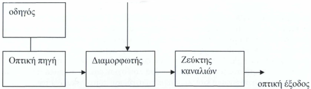
Σχήμα 3.2- Εξαρτήματα ενός οπτικού πομπού.
