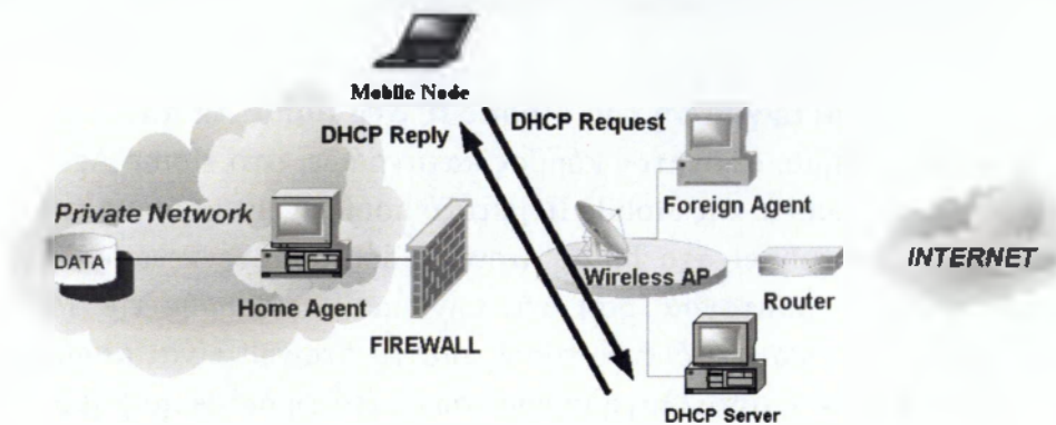
Σχήμα 46 : Απόκτηση μιας συνεγκατεστημένης Care-of-Address
