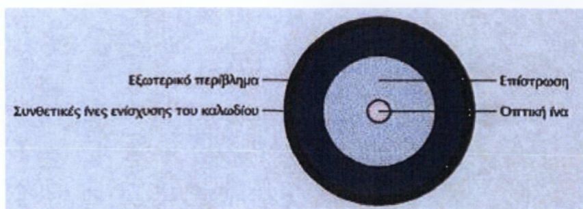
Εικόνα 9 Η κατασκευή καλωδίου οπτικής ίνας
