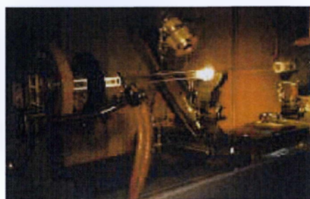
Εικόνα 8 Κατασκευή οπτικής ίνας
