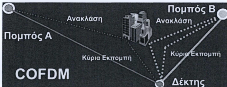
Εικόνα 3.3: Οι Ανακλάσεις στην COFDM διαμόρφωση.
