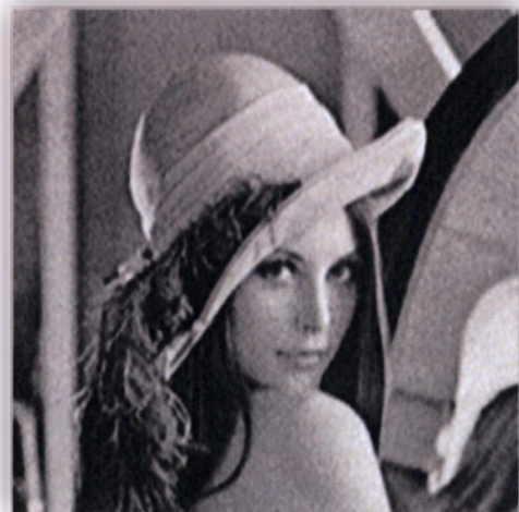
Εικόνα 4.19 - Ανασύνθεση εικόνας με το 10% των συντελεστών DCT
