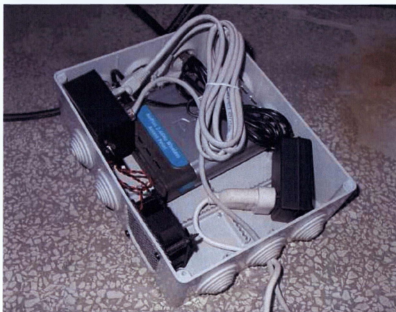
Σχήμα 1.2: Wireless Access Point τροποποιημένο για υδατοστεγή εξωτερική χρήση
