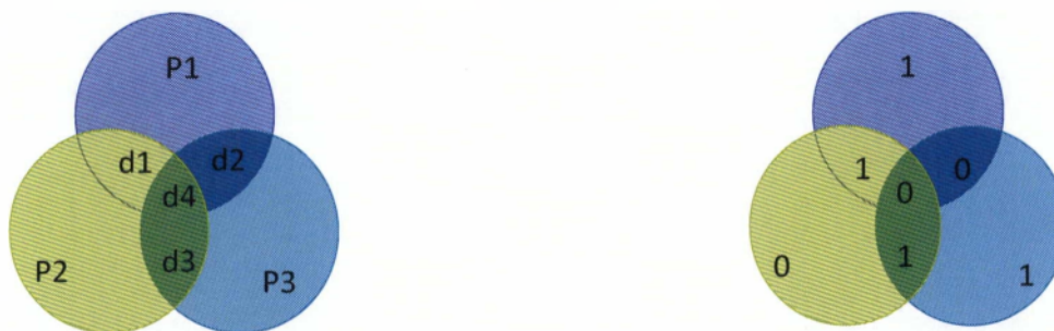
Σχ. 6 Διάγραμμα Venn. Αριστερά φαίνονται οι θέσεις των bits δεδομένων (d) και τα bits ελέγχου ισοτιμίας (P). Δεξιά έχουν τοποθετηθεί οι τιμές στο διάγραμμα για την ορθή μετάδοση της πληροφορίας 1010. (18)
