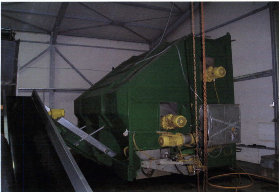
Εικόνα 8. Βίντσι γεμίσματος (αδειάζει το τούνελ)
