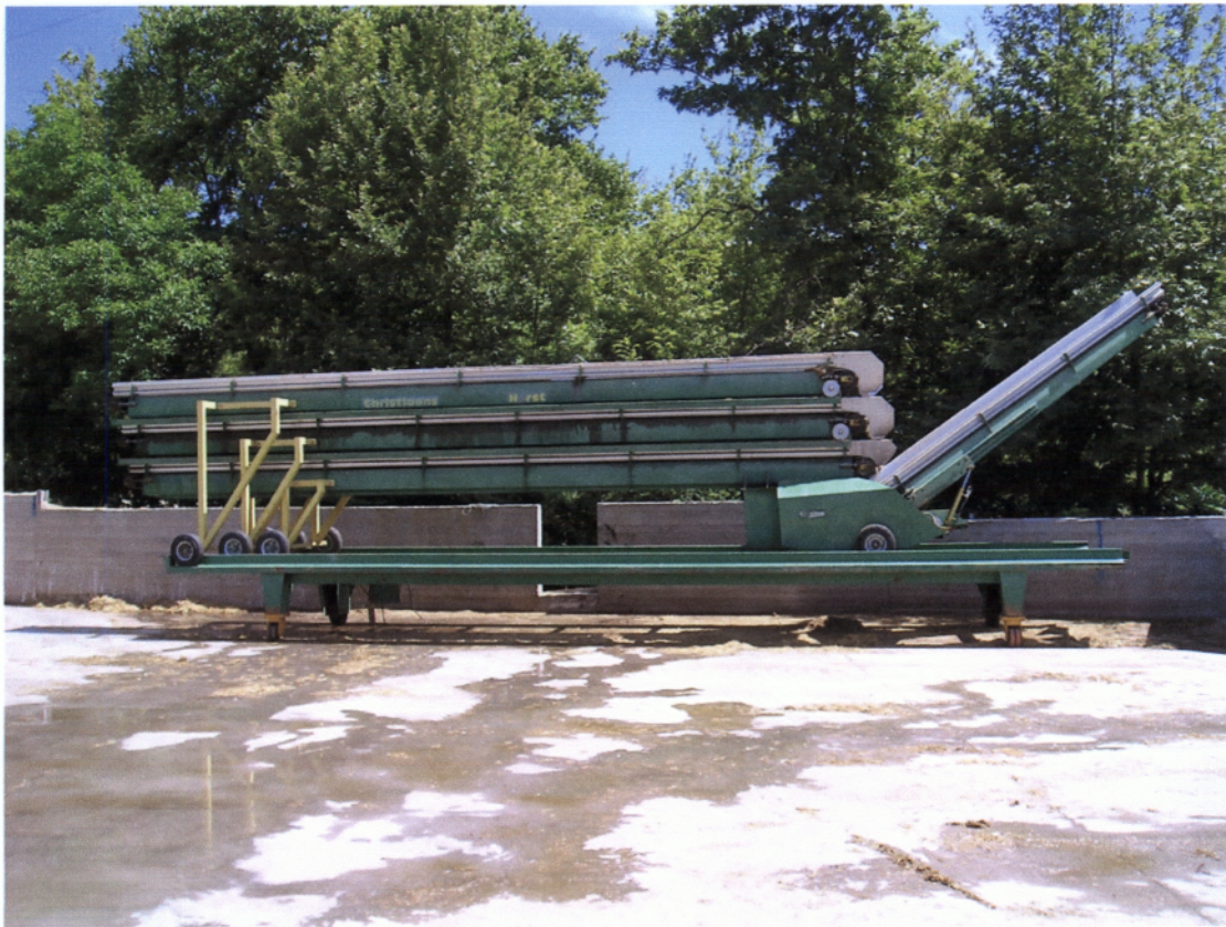
Εικόνα 7. Μηχανή γεμίσματος ( τούνελ παστερίωσης ).
