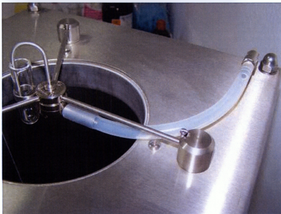
Εικόνα 4. Ψεκαστικό μηχάνημα ακριβείας που χρησιμοποιήθηκε στο πείραμα (Laboratory Precision Spray Potter Tower)
