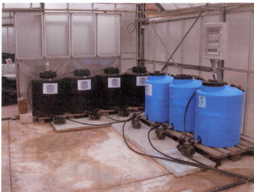
Εικόνα 4.2. Η μονάδα άντλησης και αραίωσης πυκνών διαλυμάτων που χρησιμοποιήθηκε στο πείραμα.
