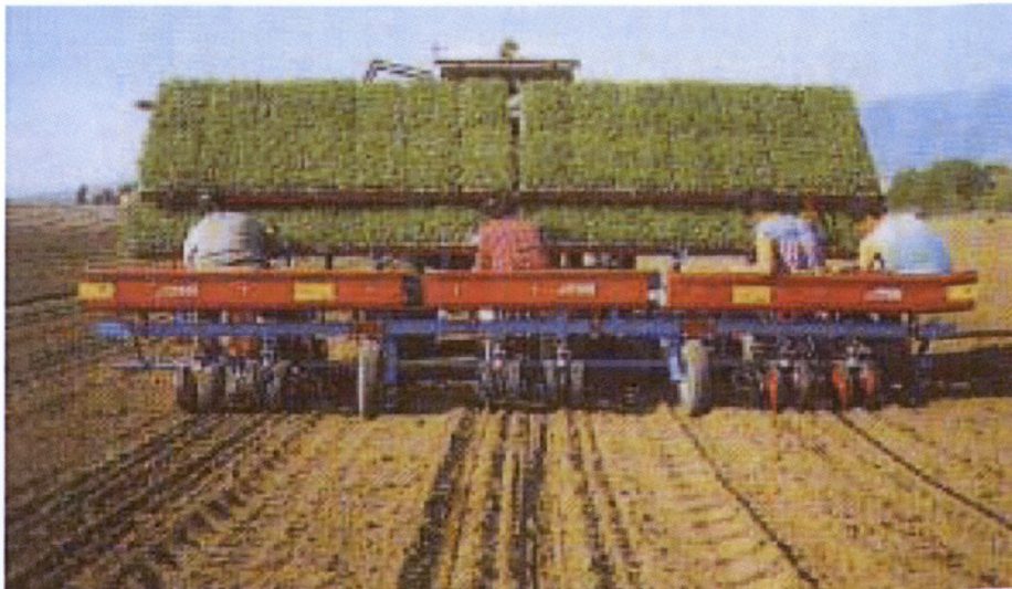
Εικόνα 6.2.1 Φυτευτική μηχανή βιομηχανικής τομάτας
