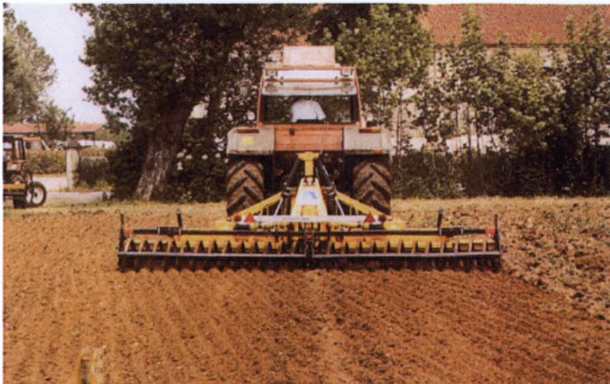
Εικόνα 5.1.2 Φρέζα για ψιλοχωμάτισμα του εδάφους
