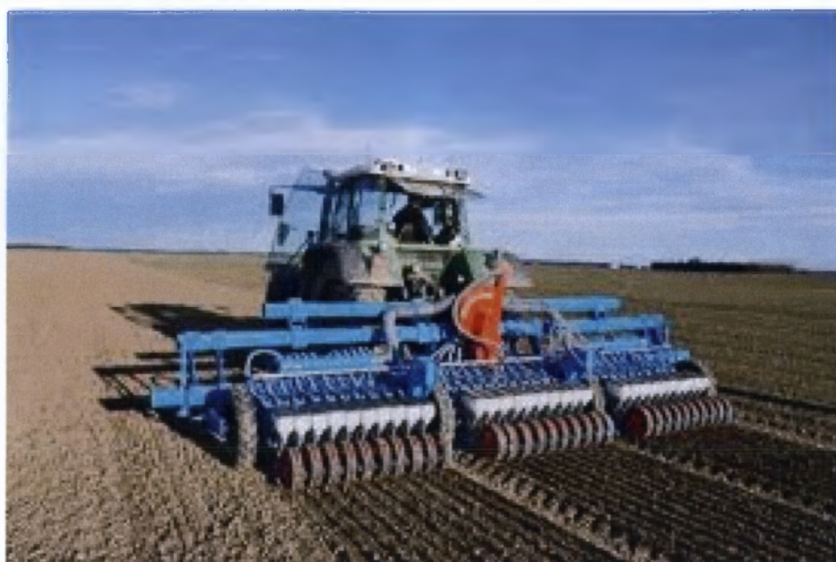
Εικόνα 2.8. Μηχανική γραμμική σπορά κρεμμυδιού σε 10 γραμμές/ανάχωμα με καλλιεργητή (σπαρτική μηχανή) 30 σειρών σε αγρό.
