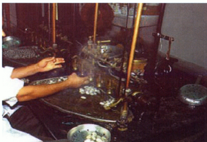
Εικ.39. Αναπήνιση κουκουλιών σε παλαιού τύπου αναπνιστήριο
