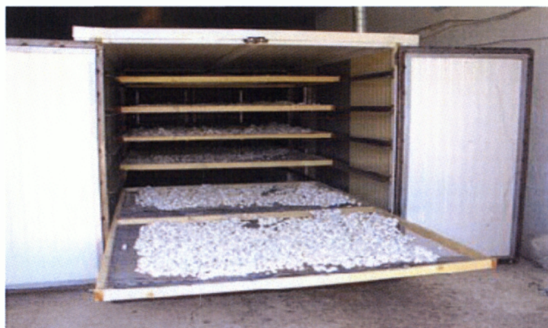
Εικ.36. Η απόπνιξη με ξηρό-θερμό αέρα
