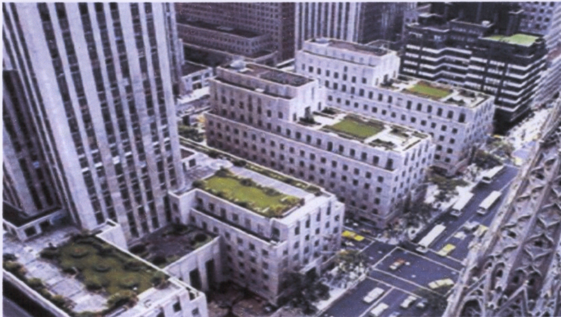
Εικόνα 3.Αεροφωτογραφία που απεικονίζει τις πέντε εντατικές πράσινες στέγες στο κέντρο του Rockefeller της Νέας Υόρκης.
