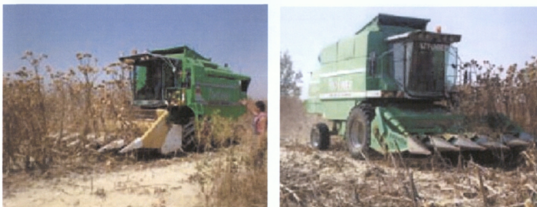
Εικ. 11. Συγκομιδή σπόρου αγριοαγκινάρας με καλαμπομάχαιο (αριστερά) και ηλιομάχαιο (δεξιά).
