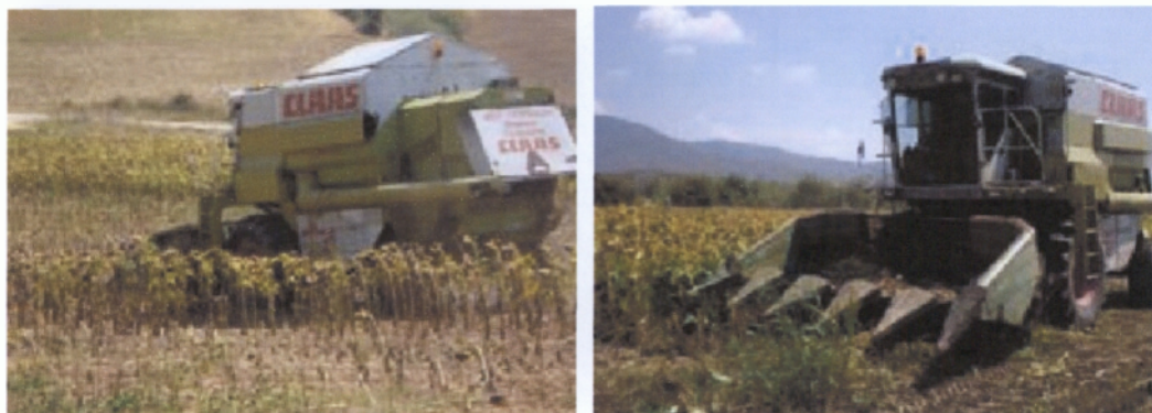
Εικ. 25. Συγκομιδή ηλίανθου με ηλιομάχαιρο σε πειραματικούς αγρούς στο Κιλκίς.
