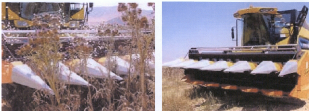
Εικ. 10. Πρότυπο μαχαίρι για τη συγκομιδή σπόρου από καλλιέργεια αγριοαγκινάρας.
