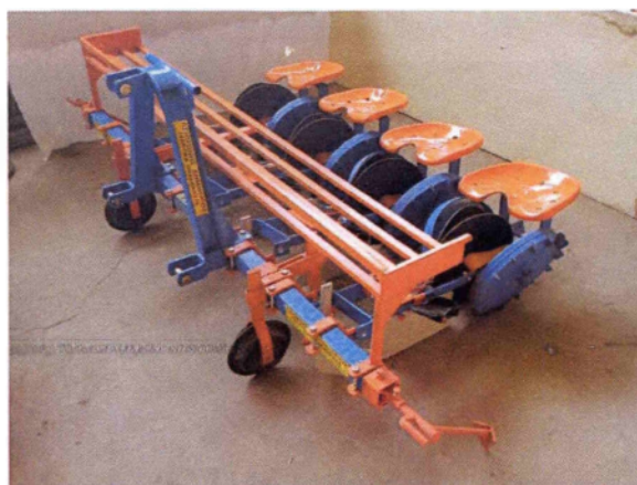
Εικόνα 2.4: Φυτευτική μηχανή τεσσάρων θέσεων
