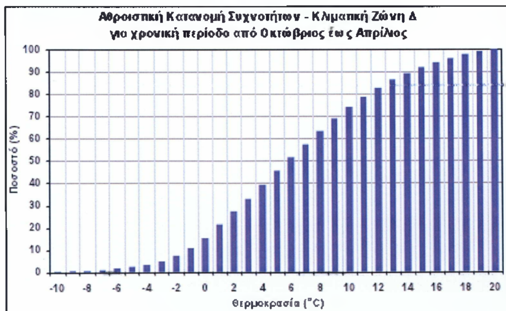
Πίνακας 9: Αθροιστική κατανομή συχνοτήτων θερμοκρασίας εξωτερικού αέρα για την κλιματική Ζώνη Δ από τον μήνα Οκτώβριο έως Απρίλιο
