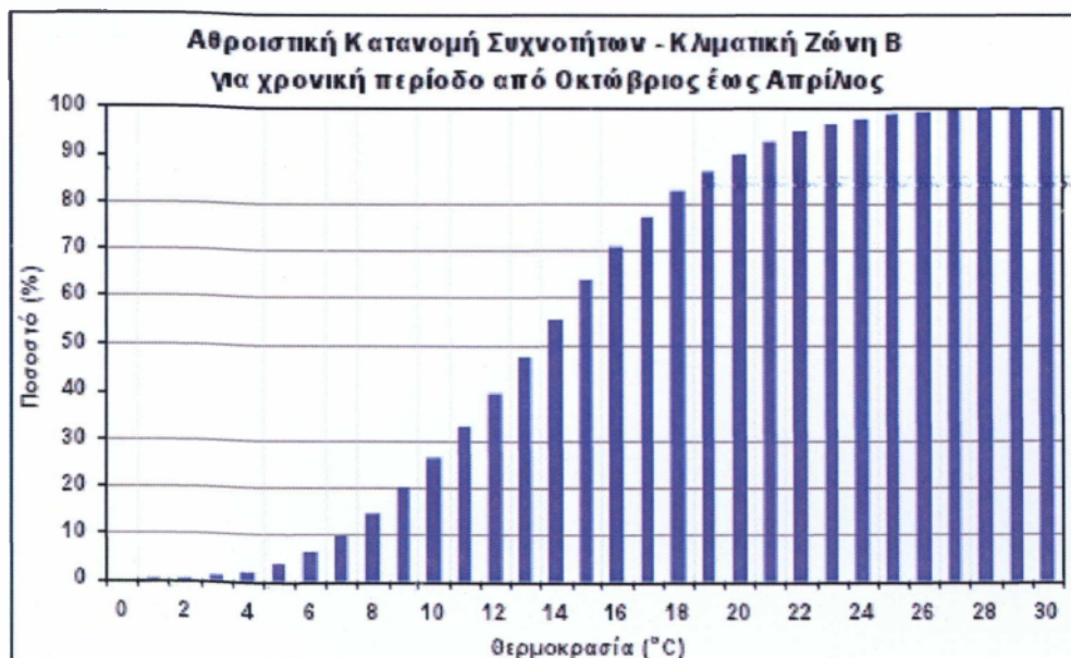
Πίνακας 5: Αθροιστική κατανομή συχνοτήτων θερμοκρασίας εξωτερικού αέρα για την Κλιματική Ζώνη Β από τον μήνα Οκτώβριο έως Απρίλιο
