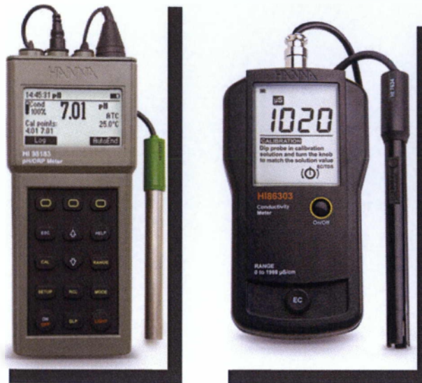
Εικόνα 2.3: Αριστερά, φορητό πεχάμετρο για την μέτρηση του pH του θρεπτικού διαλύματος και δεξιά, φορητό αγωγιμόμετρο για την μέτρηση της ηλεκτρικής αγωγιμότητας ( http://www.hannagreece.gr ).
