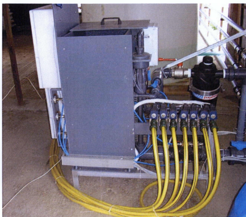
Εικόνα 2.2: Σύστημα αυτόματης ανάμειξης των πυκνών διαλυμάτων ( http://www.agrek.gr/vdroponia-kaliergies.html ).
