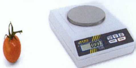
Εικ. 11. Ζυγός KERN 440-33N για τον προσδιορισμό της απώλειας βάρους των καρπών.
