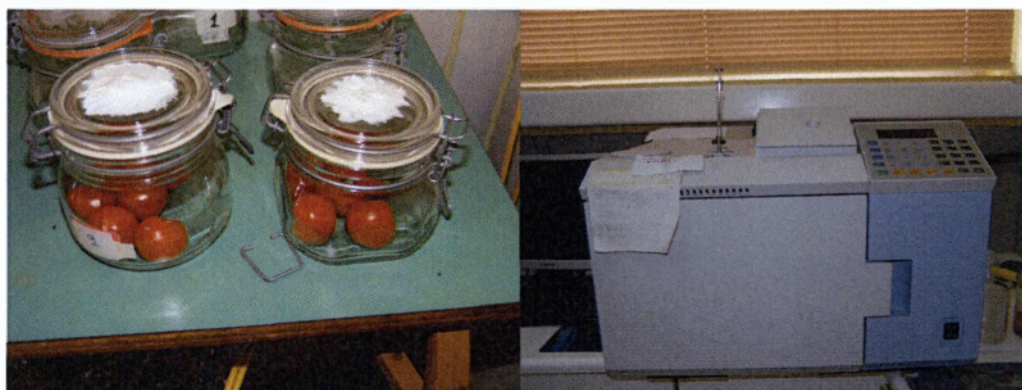
Εικ.10.Δοχεία στεγανά για τον προσδιορισμό του αιθυλενίου και αέριος χρωματογράφος.
