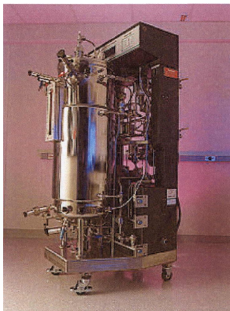
Εικόνα 19: Αντιδραστήρας λιγνοκυτταρινικής αιθανόλης
