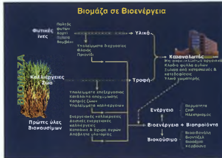
Εικόνα 2 : Σχηματική μετατροπή της βιομάζας σε βιοενέργεια
