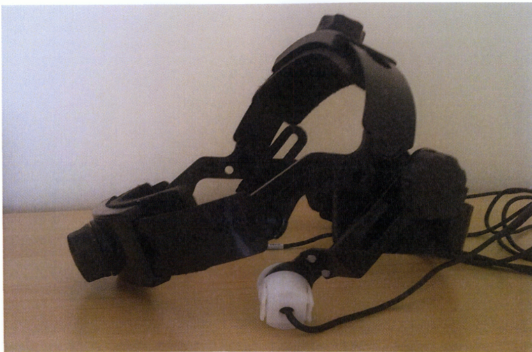
Εικόνα 7. Αισθητήρες/ηχοβολείς 2 MHz του διακρανιακού υπερήχου Doppler.
