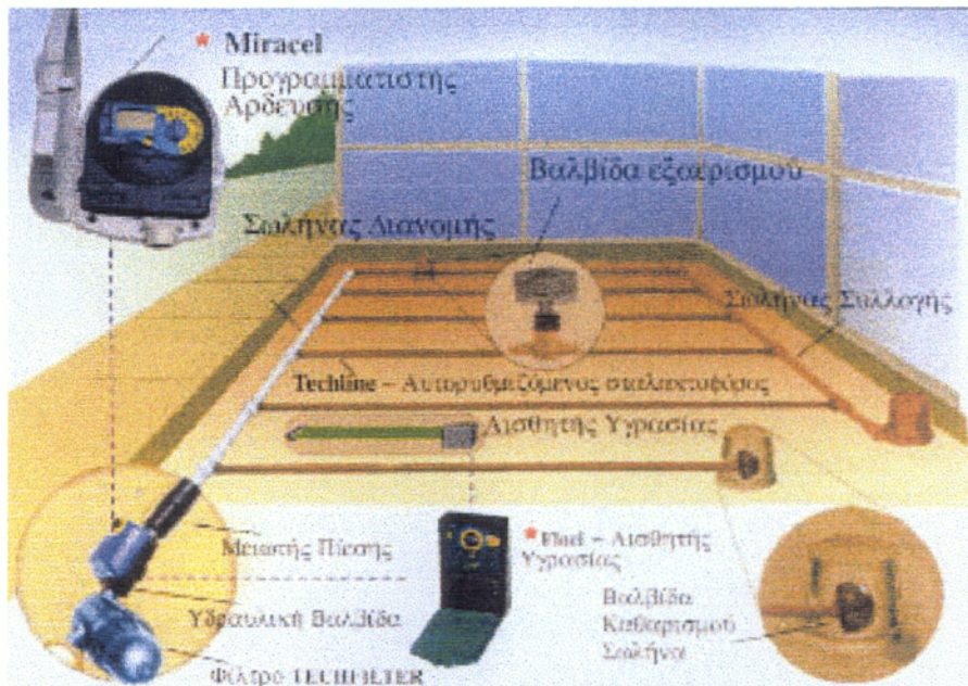
Εικ. 1: Τυπικό Παράδειγμα Υπόγειας Τοποθέτησης
