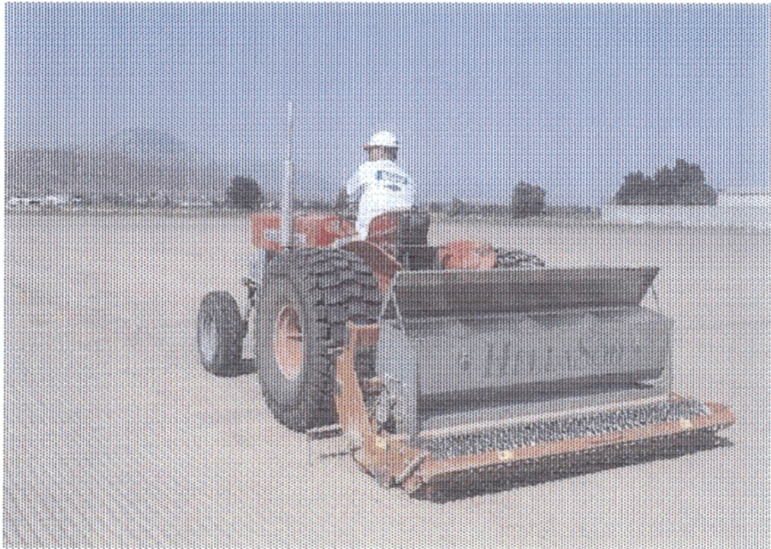
Εικόνα 2: Σπορά με τη βοήθεια σπαρτικής μηχανής (Διαδίκτυο 4)
