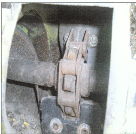
το εσωτερικό του αναβατορίου του οδηγεί το σπόρο στο σύστημα αλωνισμού
