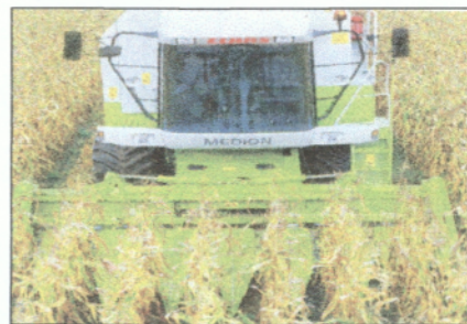
Κεφάλες κοπής (μαχαιριά) καλαμποκιού 6 σειρών
