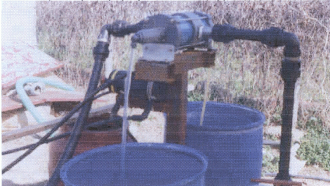
ΕΙΚΟΝΑ 16 Υδραυλική δοσομετρική αντλία κατάλληλη για εφαρμογή υδρολίπανσης
