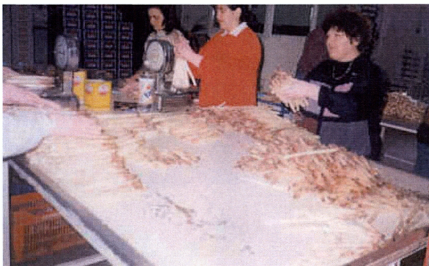
Εικόνα 1.9: Πρώτος τρόπος ποιοτικής διαλογής σπαραγγιών: Διαχωρισμός λευκών, βιολέ, πράσινων και κατά κατηγορία μεγέθους. Πηγή: www.ilios-sparagi.gr
