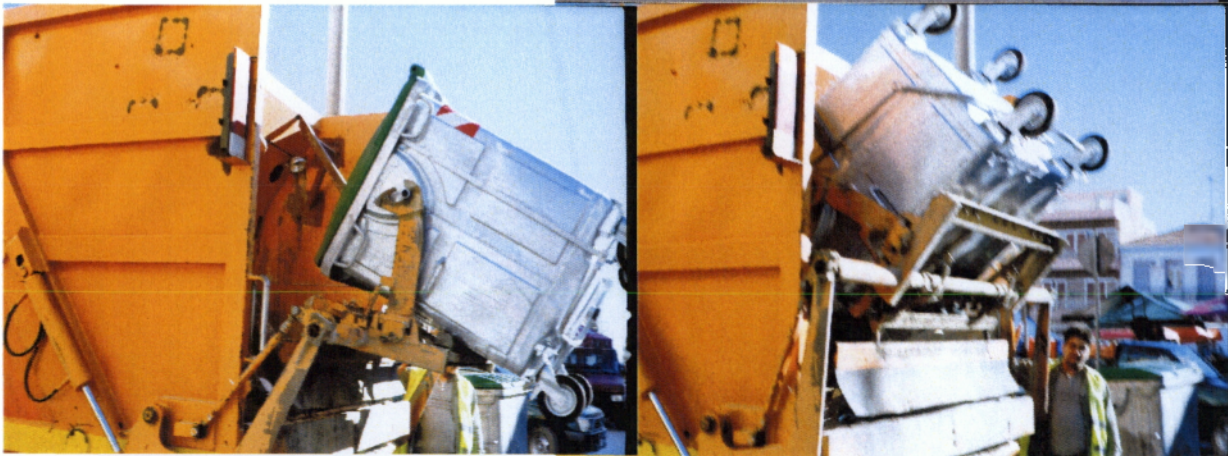
Εικόνα 8-5: Συλλογή απορριμμάτων με υδραυλικό μηχανισμό
