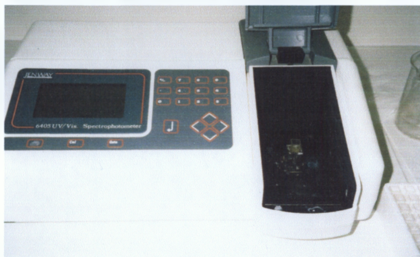
Εικόνα: Τοποθέτηση της κιβέτας στο φασματοφωτόμετρο για την μέτρηση της συγκέντρωσης της χλωροφύλλης
