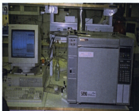
Εικ.4 & 5 Το σπεκτροφωτόμετρο αερίου είναι ένα πολύ σημαντικό εργαλείο για την απομόνωση και αναγνώριση των ουσιών αυτών
