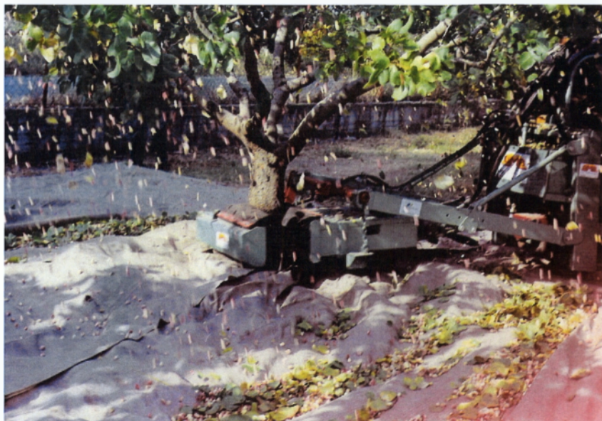
Εικ. 2.14: Μηχανική συγκομιδή με δονητή κορμού στο Σ.Γ.Ε. Βαρδατών.
