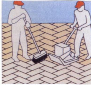
Εικόνα 19. Πίεση στοιχείων σκυροδέματος με επίπεδο δονητή και σκούπισμα αυτού (Τριανταφύλλου, 2003).
