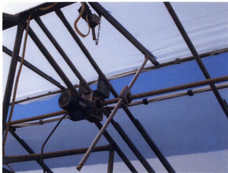
Εικόνα 2.5. Μηχανισμός ανοίγματος πλαϊνών παραθύρων.
