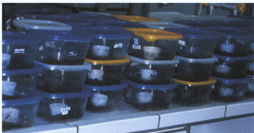
Εικόνα 19. Τα πλαστικά δοχεία. Εγκατάσταση δοκιμής μέτρησης της μεταβολικής δραστηριότητας ( CO_2 - C ) με την χρήση παγίδας NaOH.
