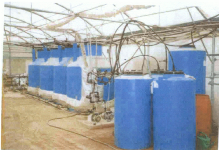
Κεντρική δεξαμενή θρεπτικού διαλύματος και δεξαμενές ιχνοστοιχείων και οξέων
