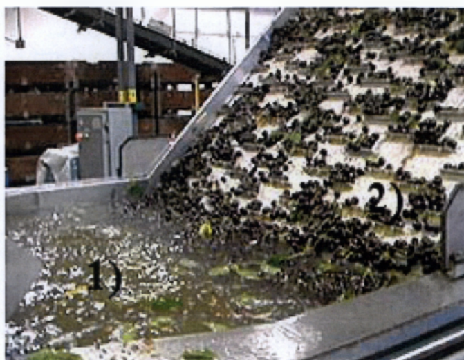
Εικόνα 2.2: 1.Δεξαμενή νερού 2.Αναβατόριο
