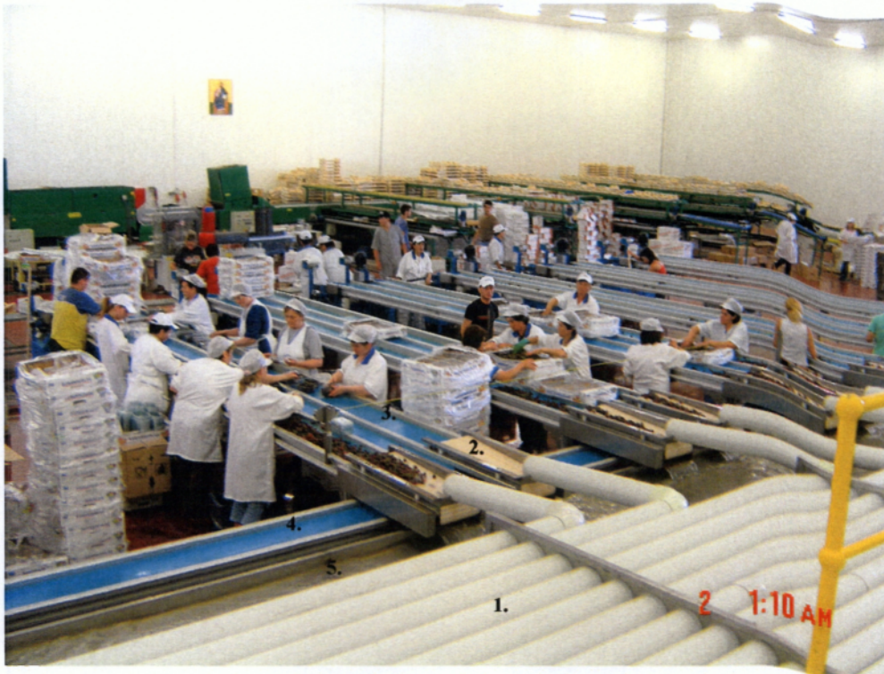
Εικόνα 9.2: 1. Σωλήνες μεταφοράς 2. Μεταφορικές ταινίες απομάκρυνσης νερού 3. Διπλές ταινίες ταξινόμησης/συσκευασίας και κεντρική ταινία απορριμμάτων 4. Κοινή μεταφορική ταινία απορριμμάτων 5. Κανάλι συλλογής νερού
