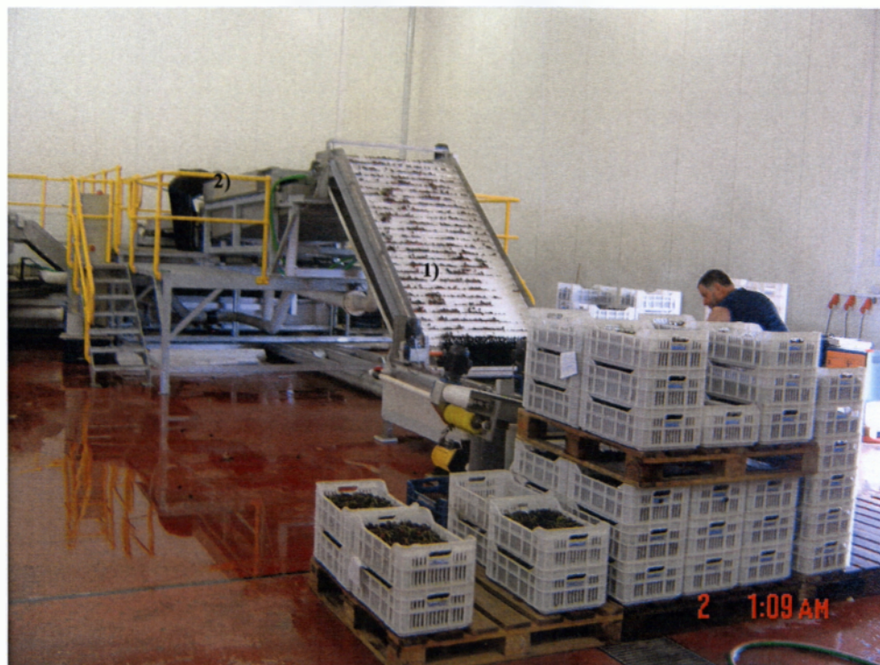
Εικόνα 2.3: 1.Αναβατόριο, 2.Κόπτης συστάδων κοτσανιών
