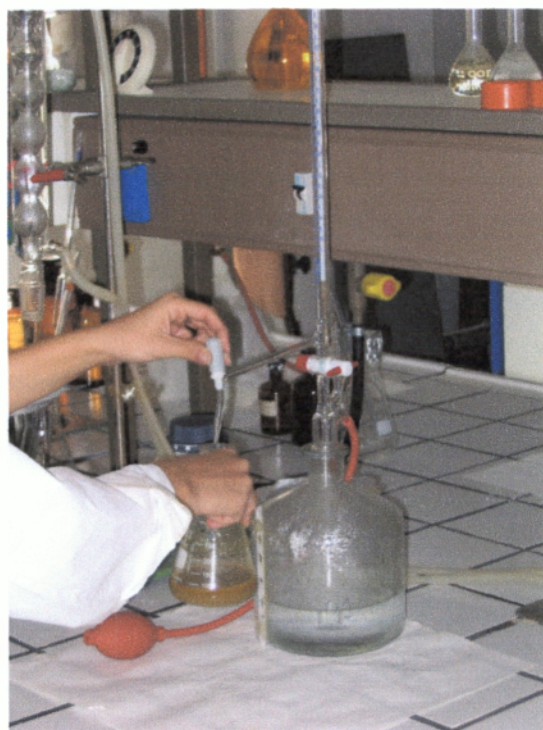
Εικόνα 6.3. Ογκομέτρηση με διάλυμα θειοθειϊκού νατρίου
