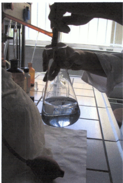
Εικόνα 3.4. Ογκομέτρηση με διάλυμα ιωδίου – εμφάνιση κυανού χρώματος
