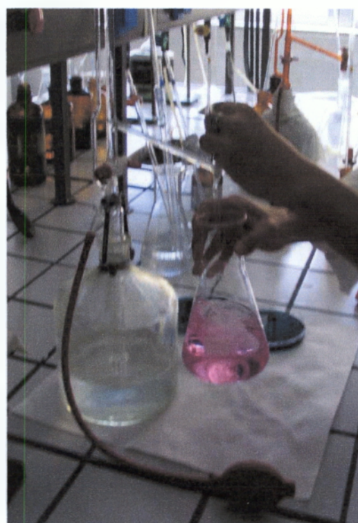
Εικόνα 3.3. Εμφάνιση ρόδινου χρώματος μετά το τέλος της ογκομέτρησης
