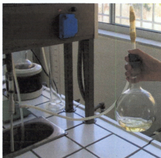
Εικόνα 2.1. Απομάκρυνση διοξειδίου του άνθρακα- δημιουργία κενού με αντλία ύδατος
