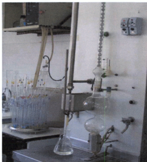
Εικόνα 3.1. Απόσταξη μεθ' υδρατμών για τη συλλογή πτητικών οξέων
