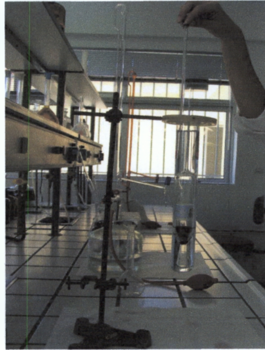
Εικόνα 1.3. Ανάγνωση θερμομέτρου και φαινομενικού τίτλου
