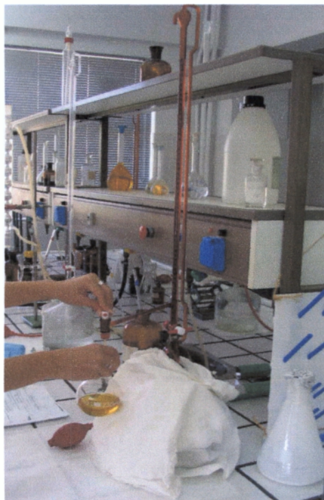
Εικόνα 4.1. Ογκομέτρηση με διάλυμα ιωδίου
