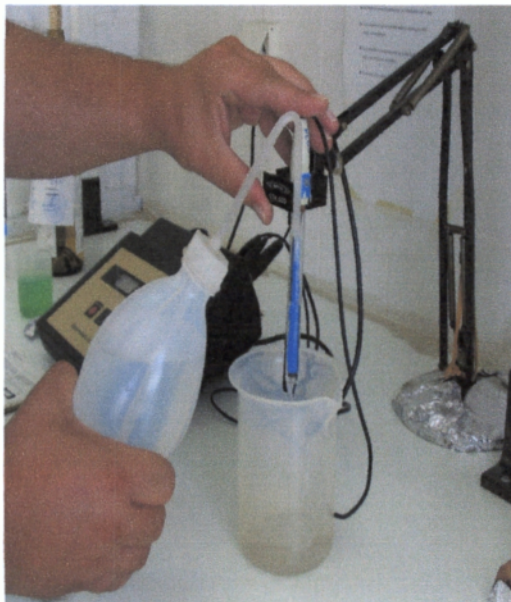
Εικόνα 5.3. Πλύσιμο ηλεκτροδίου με αποσταγμένο νερό
