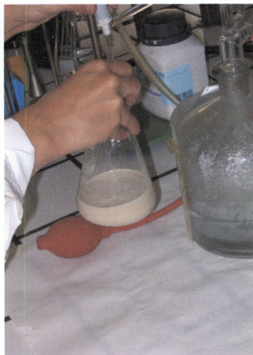
Εικόνα 6.4. Εμφάνιση λευκής χρώσης μετά το τέλος της ογκομέτρησης
