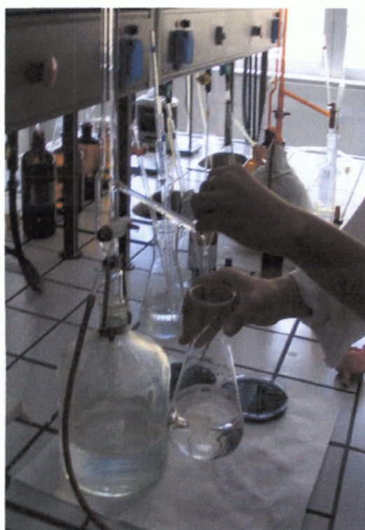
Εικόνα 3.2. Ογκομέτρηση με διάλυμα υδροξειδίου του νατρίου
