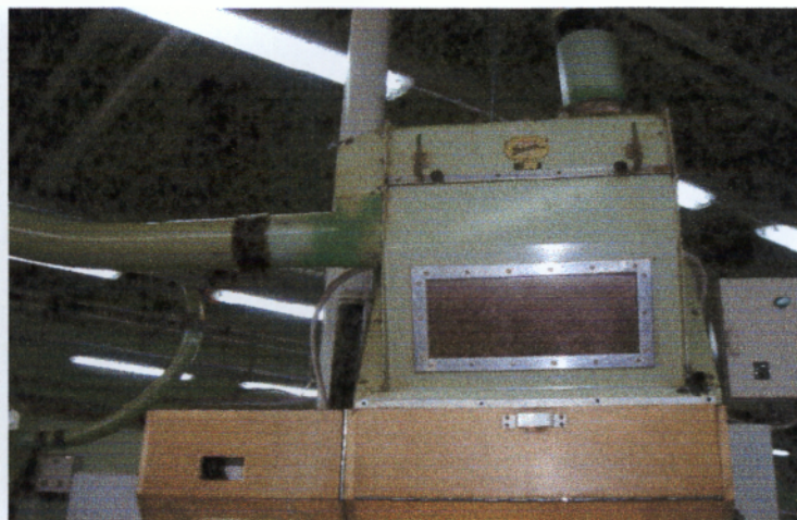
Εικόνα 68: Σύστημα αναρρόφησης έτοιμου καπνού προς τσιγαροποίηση (με παράθυρο που βλέπουμε πως κινείται ο καπνός)
