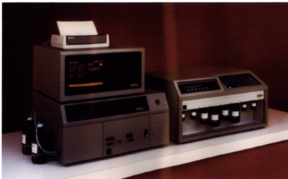
Σχήμα 8: Αναλυτής αμινοξέων αποτελούμενος από σύστημα παραγοντοποίησης και σύστημα ανίχνευσης.
