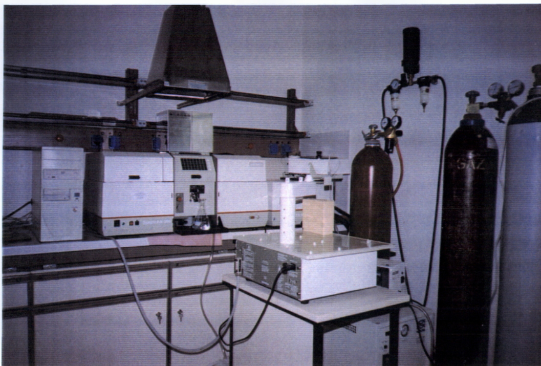
Εικόνα 9: Μηχάνημα Ατομικής Απορρόφησης με φιάλη Ακετυλενίου στο ΠΕΡΙΦΕΡΕΙΑΚΟ ΚΕΝΤΡΟ ΠΡΟΣΤΑΣΙΑΣ ΦΥΤΩΝ ΚΑΙ ΠΟΙΟΤΗΤΑΣ ΕΛΕΓΧΟΥ ΙΩΑΝΝΙΝΩΝ.
