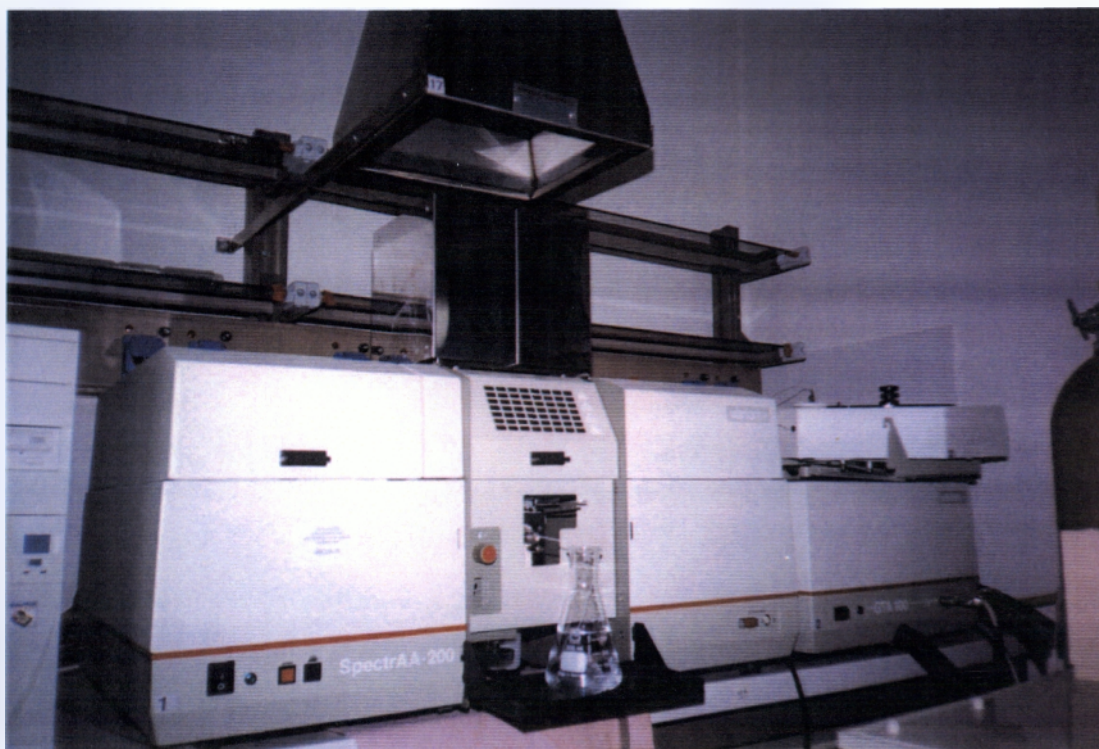
Εικόνα 10: Τα μέρη του οργάνου Ατομικής Απορρόφησης τύπου VARIAN (Spectr AA - 200)
